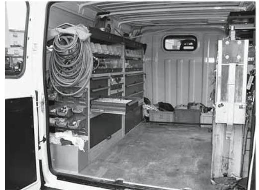
Figura 4: fissaggio del carico all'interno del veicolo.
