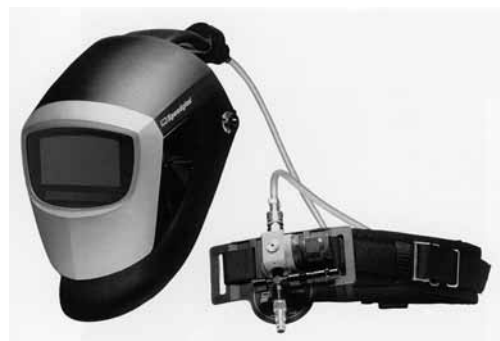
Figura 4: durante le operazioni di taglio termico o riscaldamento a fiamma in ambienti ristretti o scarsamente ventilati (ad es. serbatoi, condotte) bisogna utilizzare un respiratore ad adduzione di aria compressa completo di elmetto da saldatore.
