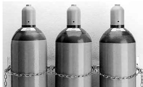
Figura 1: bombole a gas assicurate con una catena.
