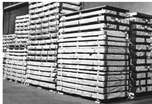
Figura 5: i legni distanziatori sistemati tra le lamiere agevolano la presa del carico con i carrelli elevatori a forche.
