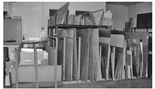
Figura 6: rastrelliere per lo stoccaggio di lamiere intere o resti di lamiera.
