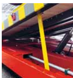
1 Piattaforma elevabile messa in sicurezza
