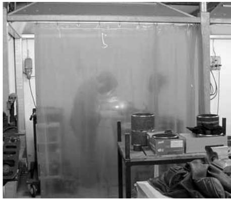
Fig. 8: per schermare i posti di lavoro vicini all'area di saldatura occorre utilizzare, ad esempio, pareti divisorie mobili di tipo ignifugo o tende di saldatura (gli schermi trasparenti devono soddisfare i requisiti della norma SN EN 1598).
