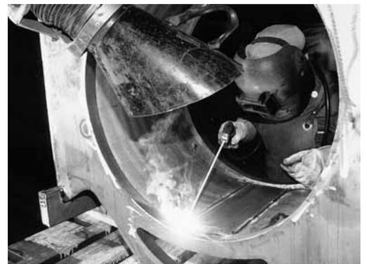
Fig. 4: cappa flessibile, a forma di coclea, per la cattura e l'aspirazione dei fumi di saldatura.
