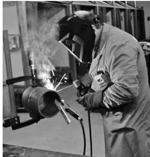
Fig. 1: prima di iniziare il lavoro il saldatore deve accertarsi che il cavo di massa sia collegato correttamente.
