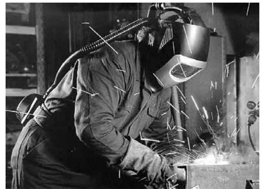
Fig. 5: quando si effettua la saldatura manuale ad arco o il taglio al plasma su pezzi legati in ambienti scarsamente ventilati occorre indossare un casco con sistema di ventilazione assistita.
