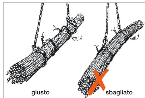
Figura 8: se non si conosce la reale portata dei ferri di supporto, c'è il pericolo che il carico possa cadere perché troppo pesante.
