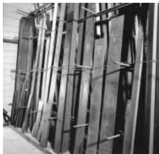
Figura 2: profilati stoccati verticalmente su rastrelliere che impediscono lo scivolamento e la caduta della merce.
