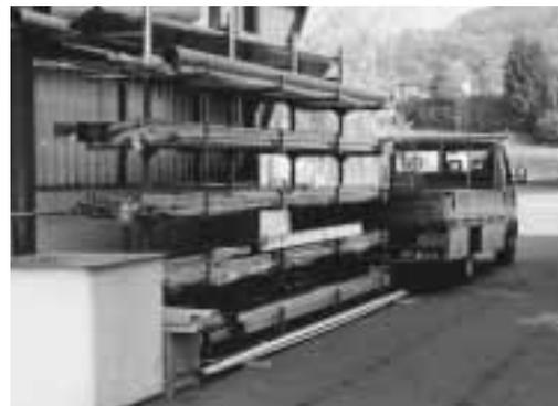
Figura 1: ricevimento della merce con rastrelliere per lo stoccaggio temporaneo in verticale.
