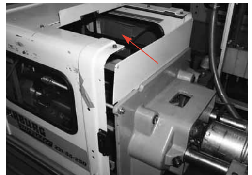
Foto 2: apertura di accesso con copertura orientabile all'indietro su una macchina di piccole dimensioni.
