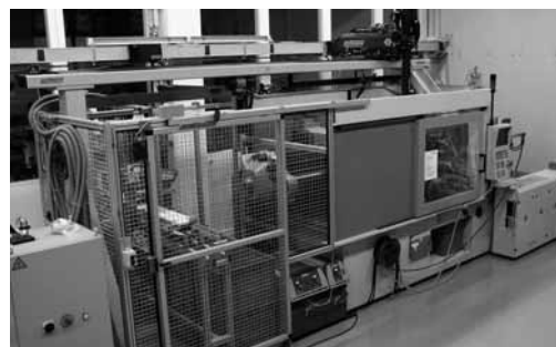
Foto 5: ampia barriera attorno ad un'isola di produzione con porta di accesso controllata da un dispositivo elettrico.
