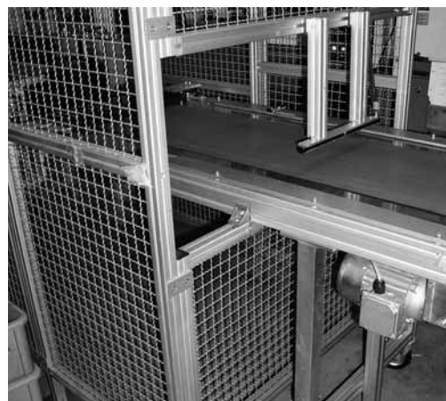
Foto 7: l'apertura al di sotto del convogliatore di scarico deve essere chiusa da una grata.
