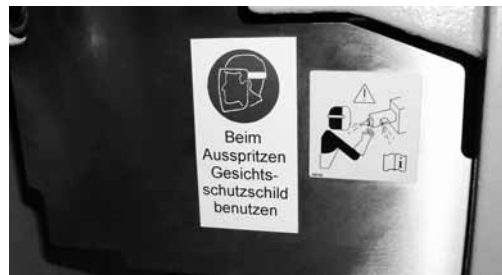
Foto 8: l'addetto all'unità di iniezione deve proteggersi dagli schizzi di materiale incandescente con una visiera di protezione, i guanti di protezione e indumenti di lavoro chiusi.
