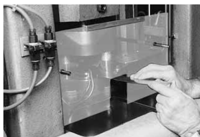
Figura 5: lavori di tranciatura su una striscia di lamiera con schermo di protezione.
