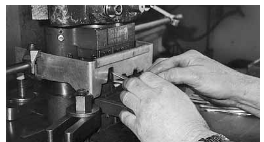
Figura 6: lavorazione di un pezzo tenuto con le mani mediante una staffa di protezione.
