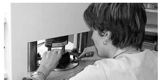
Figura 3: alimentazione manuale del pezzo da lavorare a schermatura aperta (schermo mobile interbloccato con meccanismo di ritenuta).
