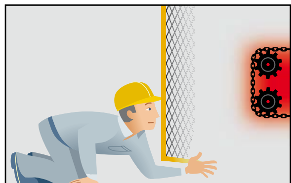
FIGURE 5-11 : ATTEINTE PAR-DESSOUS UN PROTECTEUR
