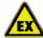
Atmosphères explosives dangereuses
