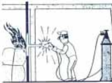
Fig. 2. Inflammation au contact de conduites invisibles chauffées.
