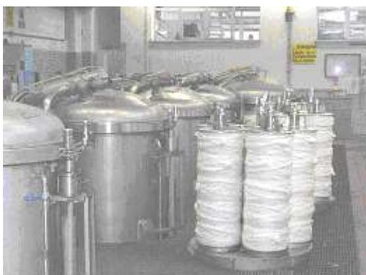
Figura 11 – Autoclavi per la tintura del top
