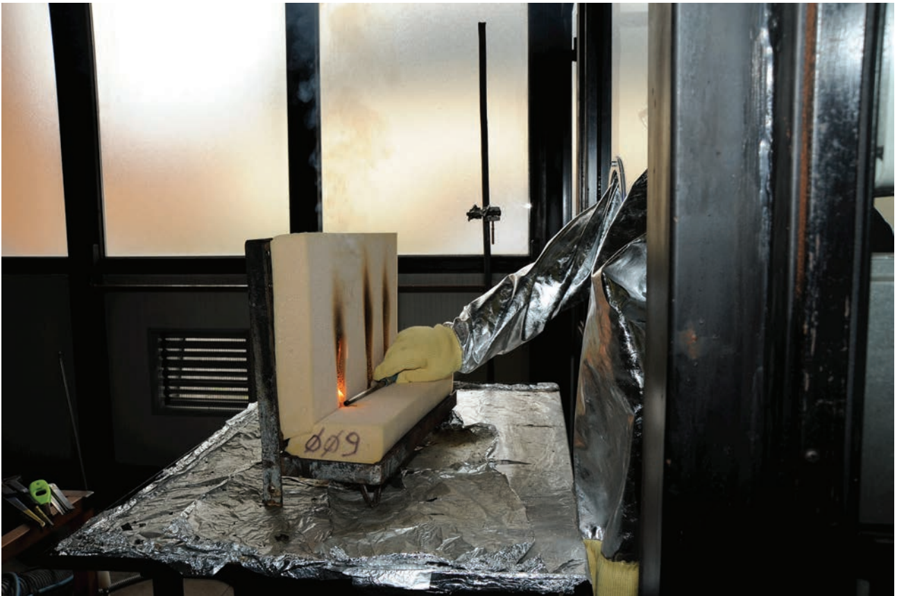
PROVA DI LABORATORIO SU MOBILI IMBOTTITI - NORMA UNI 9175
