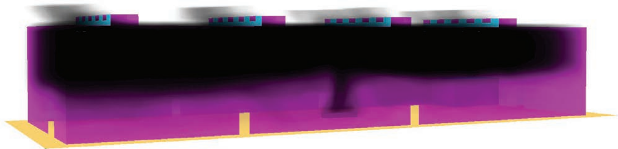
PROPAGAZIONE DEI FUMI SCENARIO B - T = 180 s
