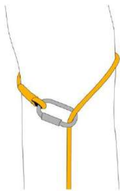
Fig. 2 - Strozzo diretto della fune
