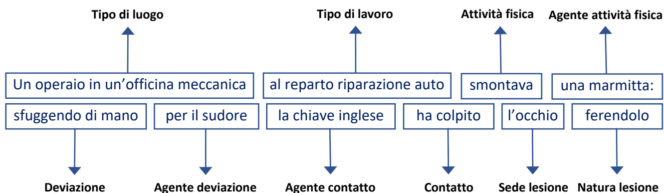
Figura 44 – Esempio di ricostruzione di un evento infortunistico attraverso le otto variabili ESAW sulle cause e circostanze e le due variabili ESAW sulla sede e la natura della lesione
