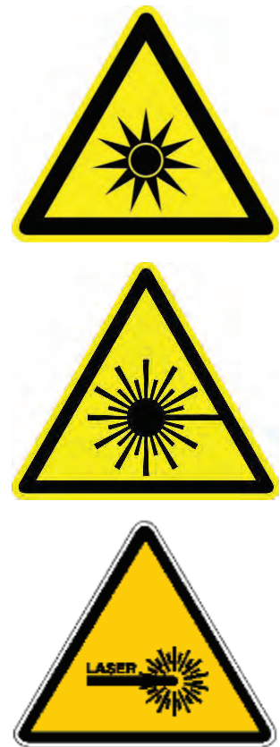
Fig. 29-a Marcatura di un'apparecchiatura con emissione di radiazioni ottiche incoerenti
