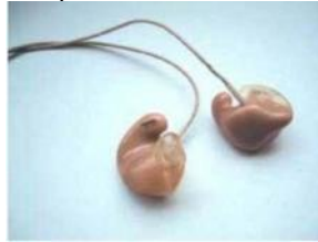
Figura 5. Monitor intrauricolari personalizzati (Fonte: Linee guida europee [1]).
