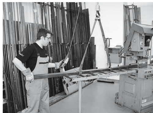
Foto 2: dispositivo di sollevamento per pezzi pesanti.
