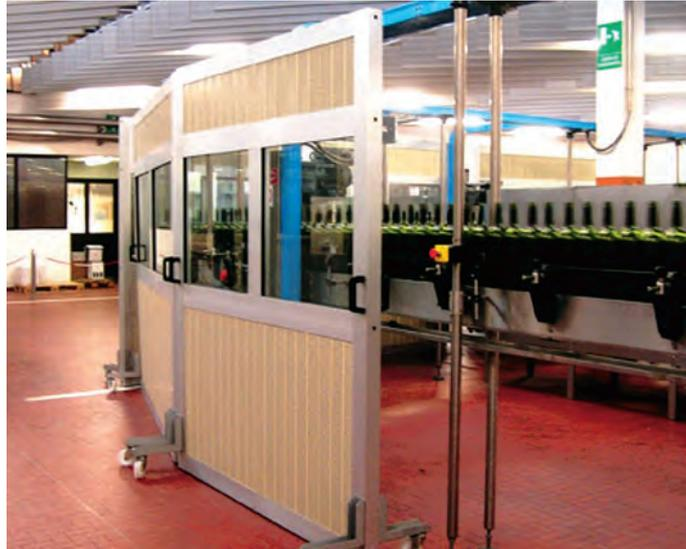
FIGURA 21 - BARRIERE FONOISOLANTI
