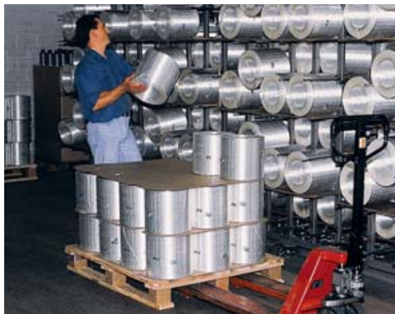
In passato le bobine di fibre di vetro del peso di 25 kg venivano posizionate manualmente per la lavorazione.
