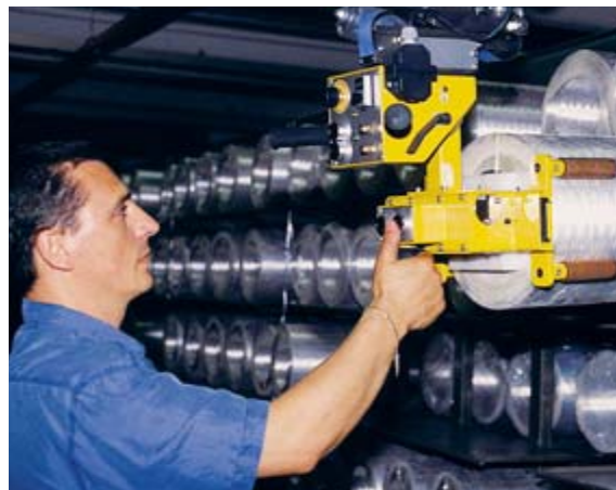
Oggi lo stesso lavoro viene effettuato con un apparecchio di sollevamento («balancer» di pesi). Grazie alla meccanizzazione, il lavoro è diventato molto più sicuro, meno rischioso per la salute e la produttività è aumentata.
