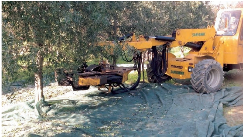
Figura 11: Raccolta delle olive con uso di scuotitore - Azienda Agricola Palma Pasquale - S. Lupo (BN)
