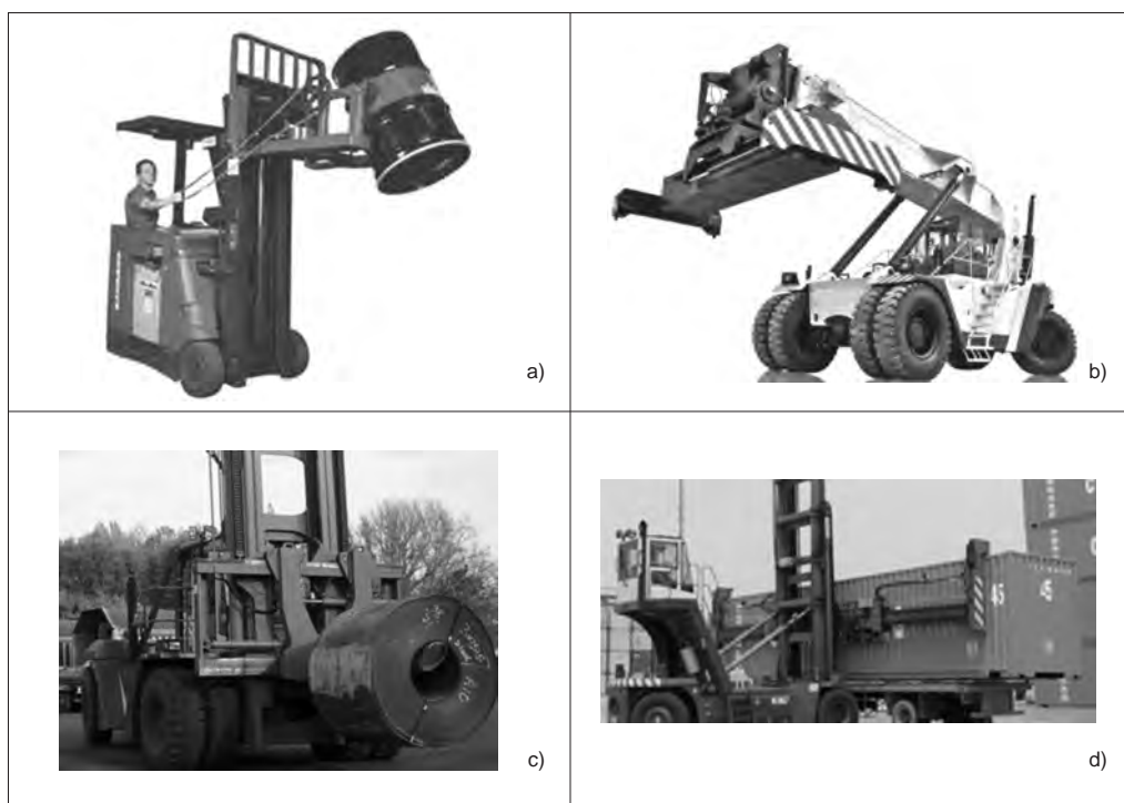
Figura 1: Esempi di macchine per operazioni di sollevamento non rientranti nella definizione di apparecchio di sollevamento di cui all'allegato VII al d.lgs. 81/08 e s.m.i.
