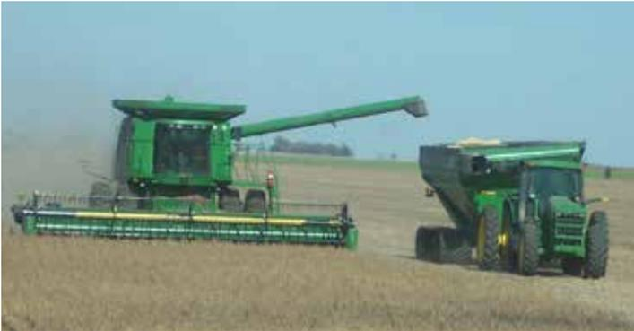
È importante rilevare che un **macchinario può comportare più di uno dei rischi** sopra indicati (ad esempio una sega circolare può causare lesioni dovute sia al **contatto** con la lama da taglio sia all'**espulsione** del legno, mentre una mietitrebbiatrice può causare sia lesioni da **impatto** sia lesioni da **impigliamento**).
