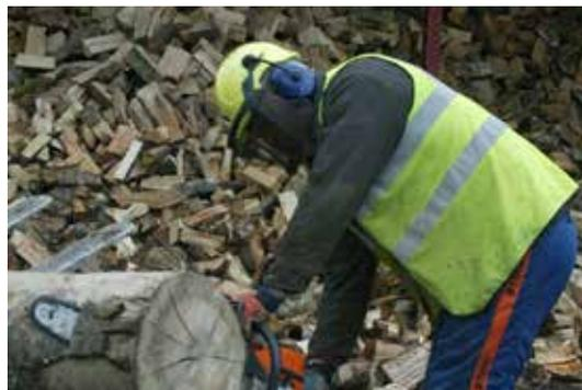
Operatore di motosega formato dotato di dispositivi di protezione individuale completi
