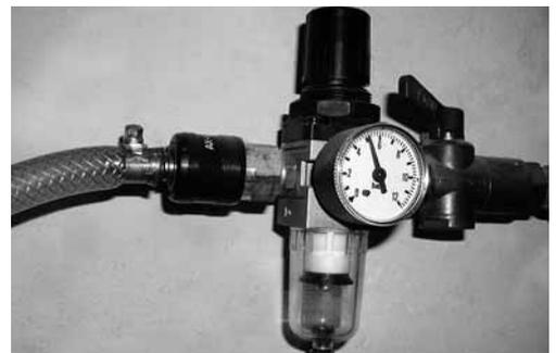
Foto 6: riduttore di pressione con valvola di sicurezza incorporata.
