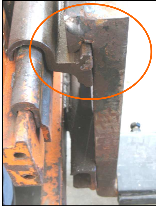
Figura 5: In evidenza mancanza fine corsa
