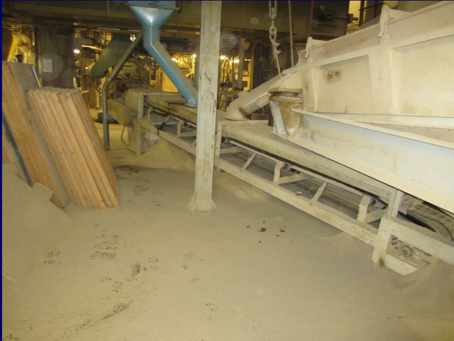
Vaglio vibrante: dispersione e accumuli di polvere
