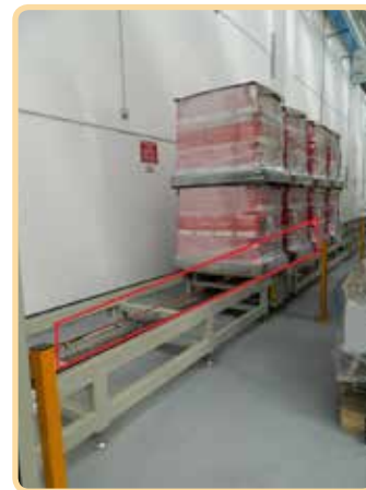
Nastro trasportatore – fune di sicurezza
