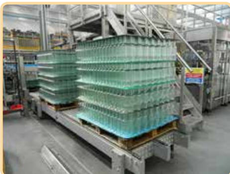
Depallettizzatore – zona carico bottiglie vuote
