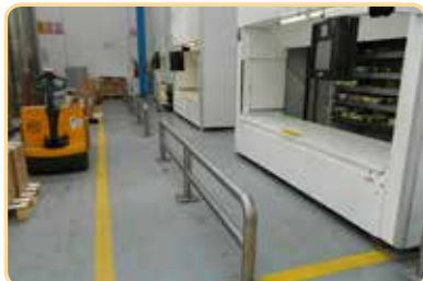
Barriere di protezione di posti di lavoro. Segnaletica orizzontale per la individuazione dei percorsi dei pedoni e dei carrelli elevatori
