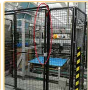
Depallettizzatore riparo mobile con interblocco
