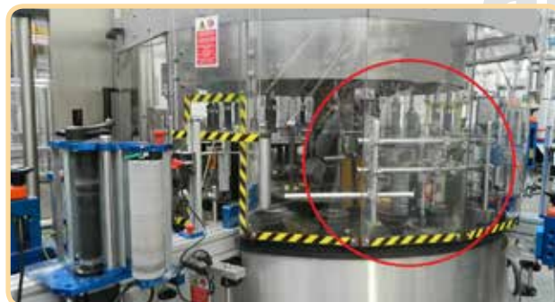
Etichettatrice – ripari mobili con interblocco
