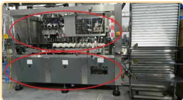
Capsulatrice – ripari fissi e ripari mobili con interblocco
