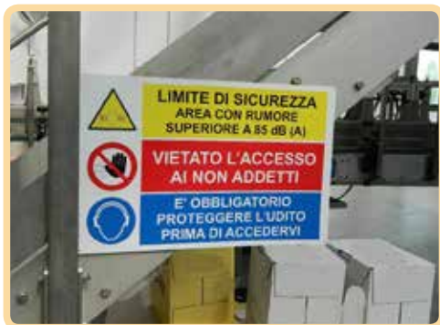
Segnaletica di sicurezza per rischio rumore
