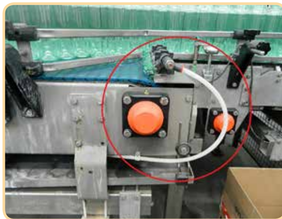
Nastro trasportatore – protezione degli organi in movimento
