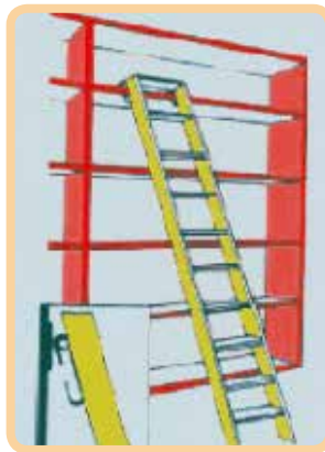
Figura 2: Dispositivi di trattenuta/antiscivolo all'estremità superiori.
