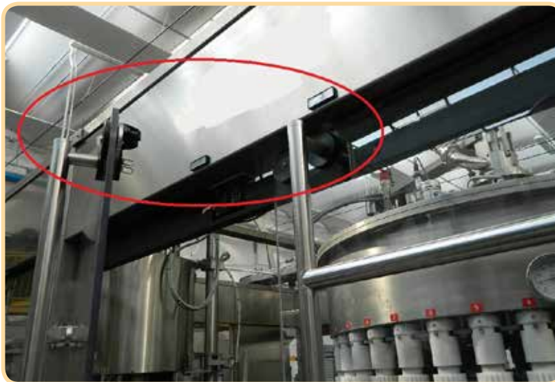
Riempitrice – Riparo mobile con interblocco; lo spessore del pannello è tale da consentire la riduzione del rumore
