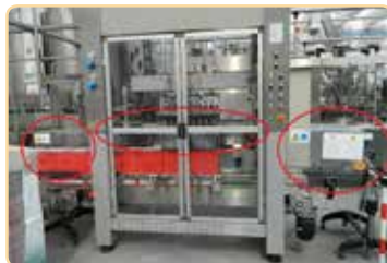
Capsulatrice – ripari fissi e ripari mobili con interblocco
