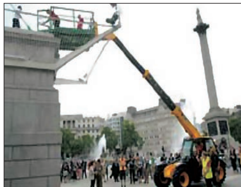
Figura 8 - Una sequenza di sbarco in quota dal cestello di una PLE
