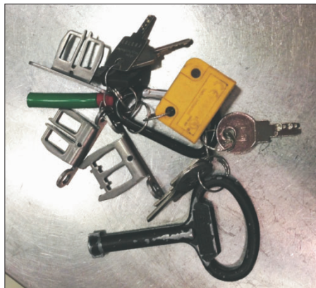
Figura 4: Kit 9 di azionatori frequentemente utilizzato per manomettere gli interblocchi di sicurezza dotati di basso livello di codifica
