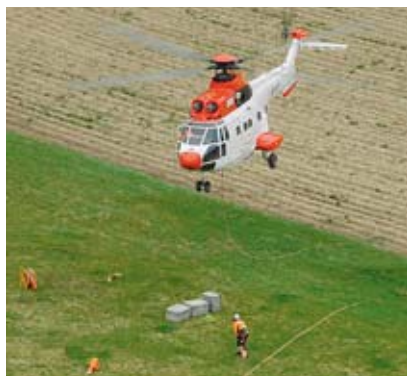
2 Le persone non autorizzate sostano al di fuori della zona di pericolo.
