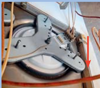
Pannello isolante leggero situato sotto la piastra elettrica di cottura
