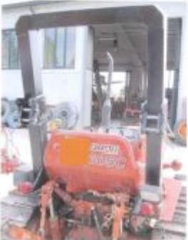
Tutte le trattrici agricole a ruote e a cingoli devono avere una struttura di protezione (cabina o telaio) del posto di guida in caso di ribaltamento.
