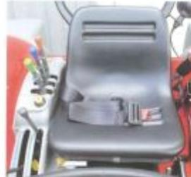
Oltre alla struttura di protezione del posto di guida, tutte le trattrici devono avere un dispositivo di ritenzione (cintura di sicurezza) che, in caso di capovolgimento del mezzo, trattiene il conducente al sedile, cioè all'interno di un volume di sicurezza.
