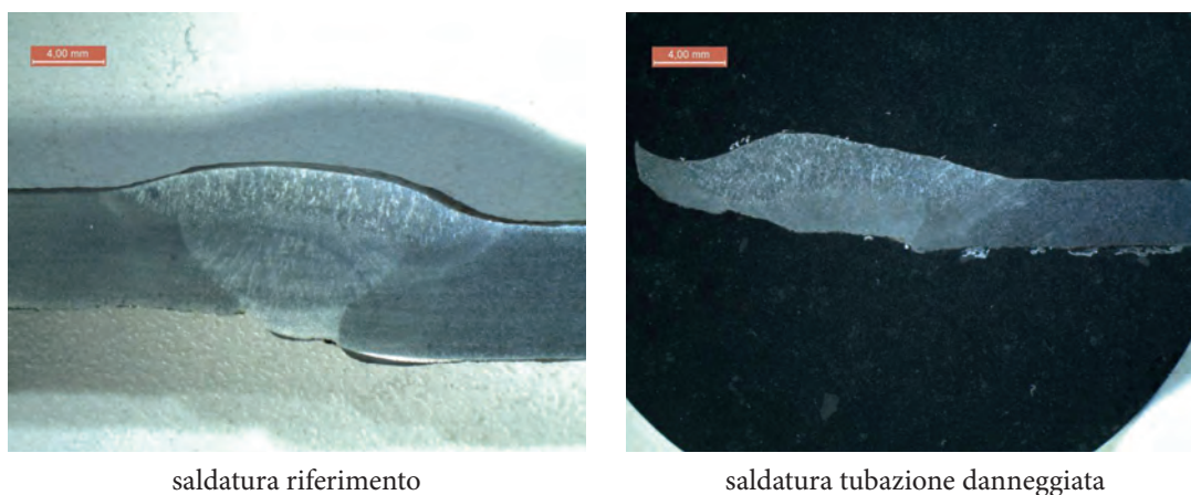
Figura 39. Macrografie di alcune saldature
