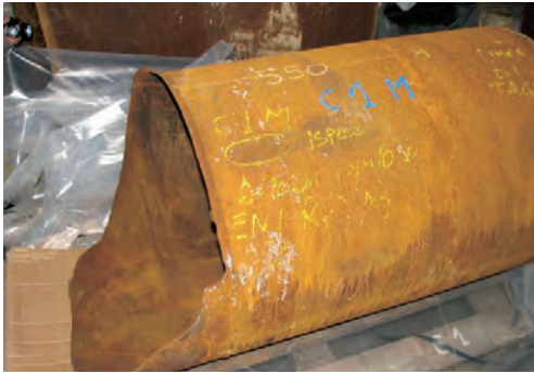
primo punto di rottura: monte
