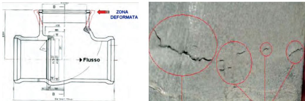
Figura 23. Zona della valvola deformata con cricche
