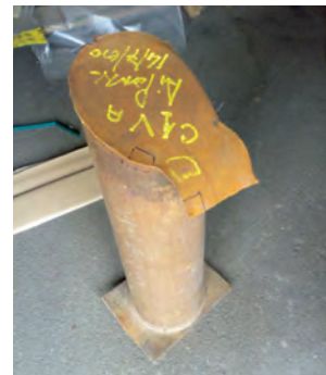
primo punto di rottura: base del supporto
