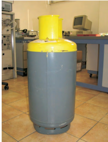
Figura 27. Il bidone utilizzato come riferimento, del tutto identico a quello esploso
