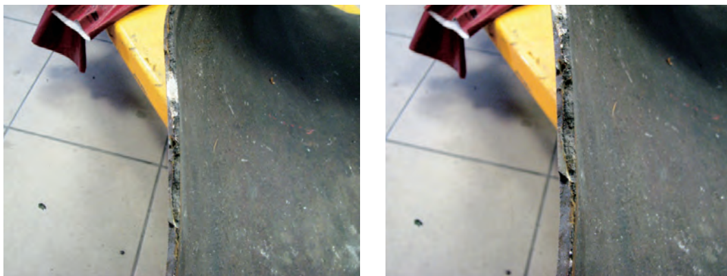
Figura 5. Alcune fotografie scattate in occasione dell'esame visivo di una bombola che ha subito una rottura per tensocorrosione: si noti il doppio strato lungo la linea di frattura
