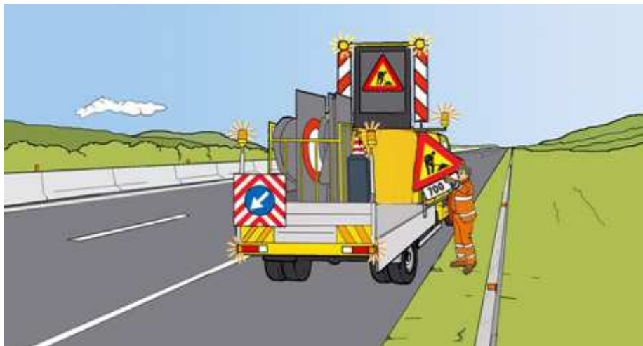
Figura 20 – Chiusura della corsia di marcia: scarico ed installazione del segnale di lavori in corso sul margine destro
