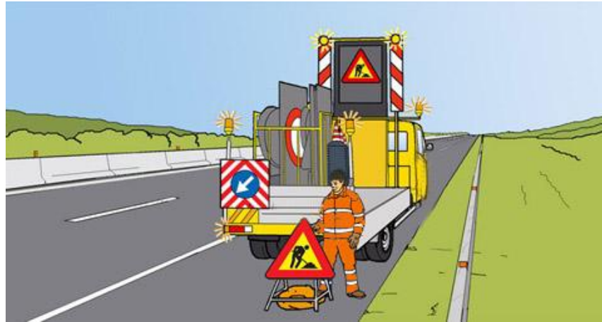
Chiusura della corsia di emergenza: installazione del cartello di lavori in corso
