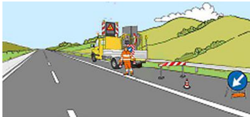
Chiusura della corsia di emergenza: installazione della testata di chiusura
