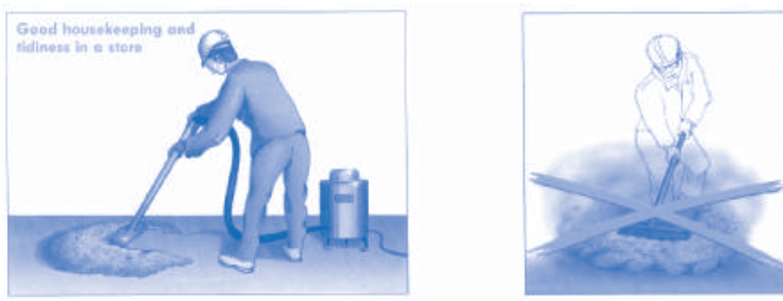
Figura 3.2: Eliminazione dei depositi di polveri. 9
