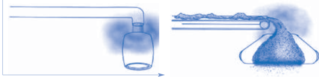
Figura 2.2: Esempi di formazione di miscele polvere/aria in procedimenti di riempimento e trasporto. 5
