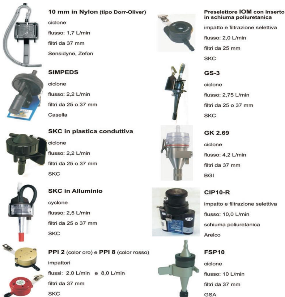
**Figura 3.1.** - Tipologia, flussi di aspirazione, substrati di raccolta del campione e produttori dei selettori personali per il campionamento delle polveri respirabili<sup>16</sup>.
