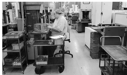
Fig. 1: prevedere uno spazio libero di almeno 800 mm per consentire all'operatore sufficiente libertà di movimento.
