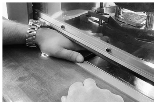
Fig. 5: schermo di protezione mobile con barra sensibile. Protegge mani e dita dallo schiacciamento.
