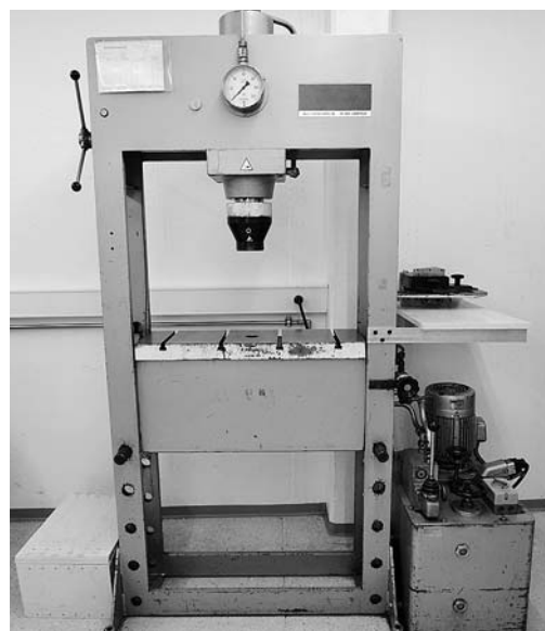
Fig. 3: pressa idraulica da officina.
