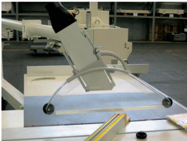
Fig. 11. Esempio di protezione sospesa
