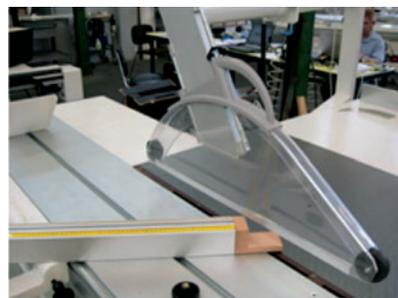
Fig. A3.2. Protezione della lama sospesa
