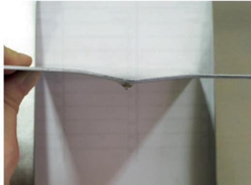
Fig. 22. Due provini di alluminio da 2 mm dopo impatto nel punto V (alto) e L (basso). I profili sono mostrati dall'alto (lato impatto) e di profilo per mostrare il tipo di deformazione plastica risultante.
