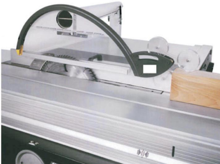
Fig. 2. Esempio di sega squadratrice con protezione sospesa
