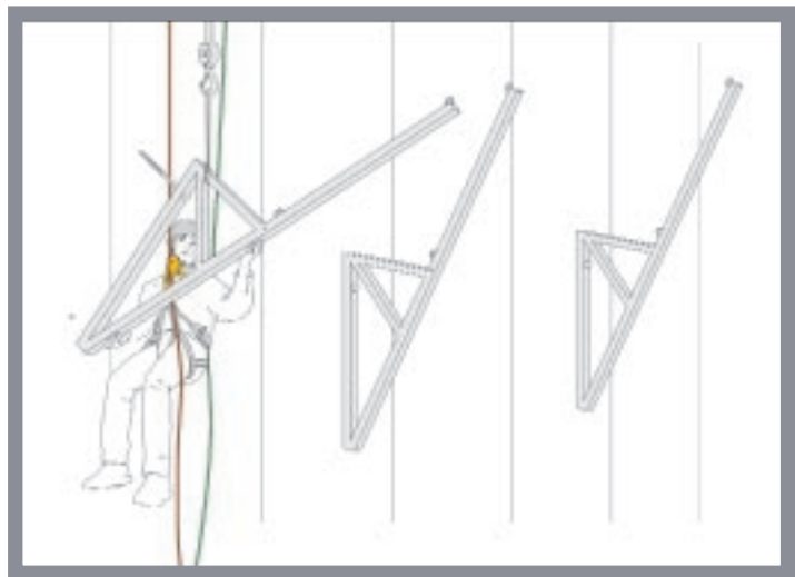
Accesso su corda per fissare i supporti di un impalcato
