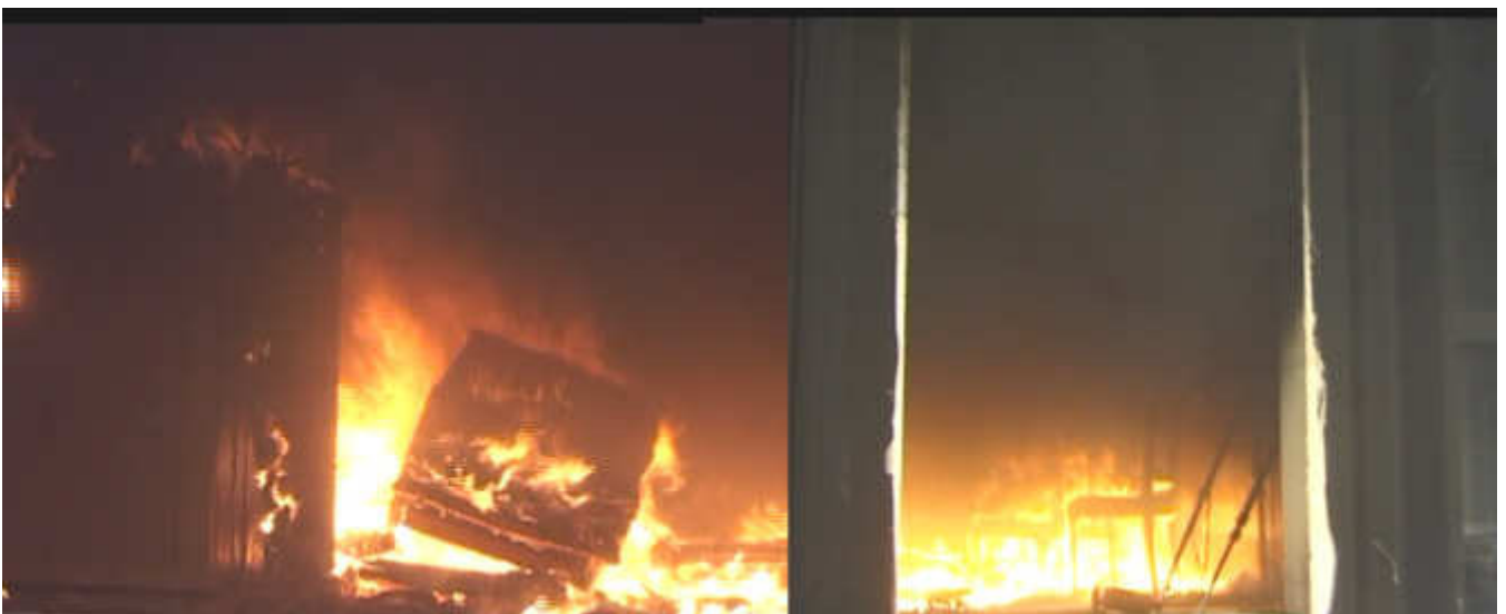
Incendio sperimentale presso il laboratorio del NIA – fase d'incendio generalizzato
