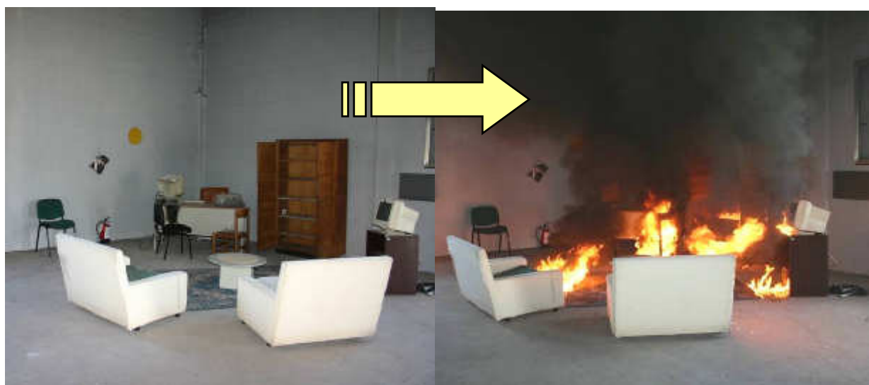
Ricostruzione di uno scenario d'incendio presso il laboratorio NIA delle SFO
