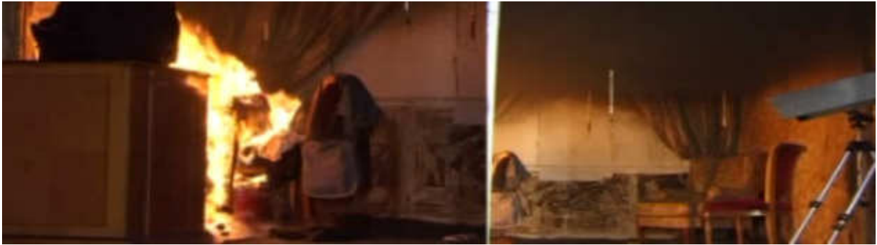
Ricostruzione di uno scenario d'incendio (camera d'albergo) presso il laboratorio NIA
