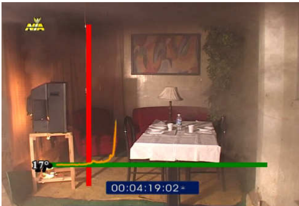
Incendio sperimentale presso il laboratorio del NIA – fase di crescita
