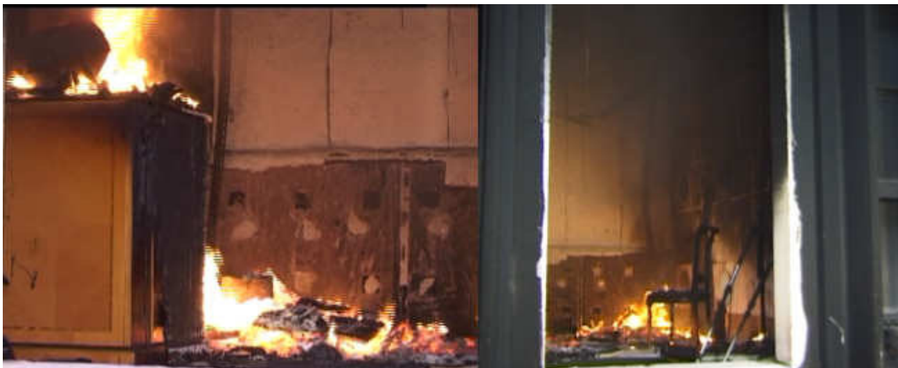
Incendio sperimentale presso il laboratorio del NIA – fase di decadimento dell'incendio
