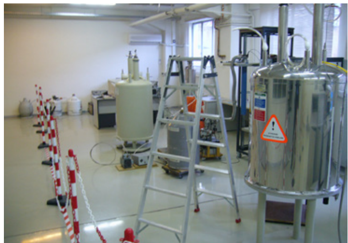
Figura 2.4 — Demarcazione dell'area ad accesso limitato tramite catena di separazione e segnalazione sul pavimento
