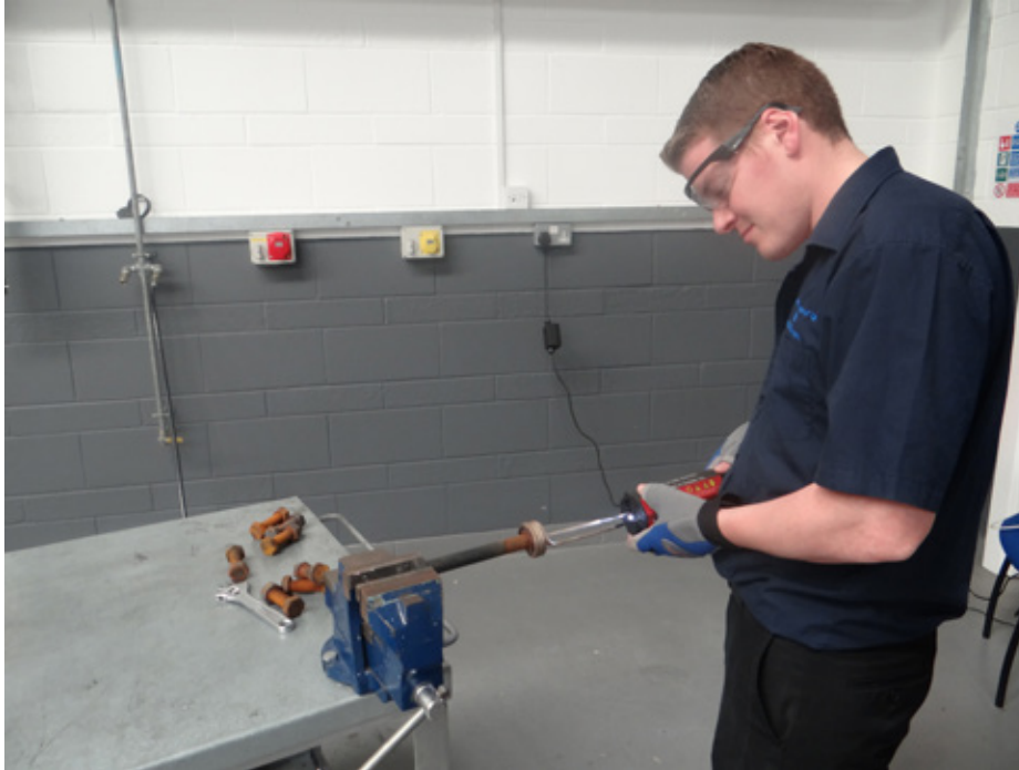
Figura 6.3 — Riscaldatore manuale a induzione da 1 kW usato per riscaldare un bullone grippato
