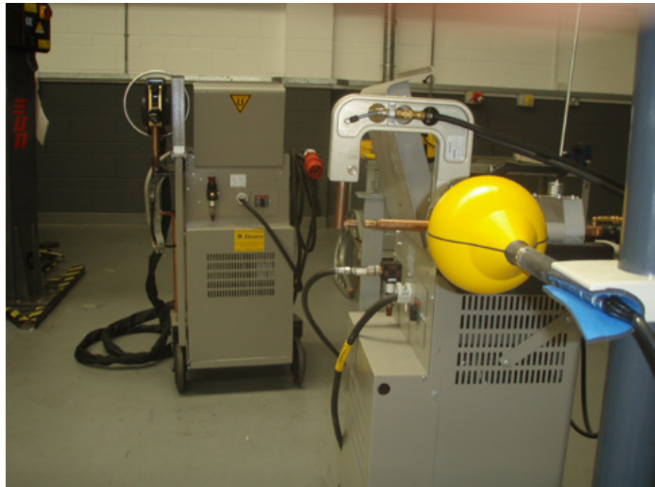
Figura 6.7 — Misurazioni effettuate intorno alla saldatrice a punti da carrozziere dotata di pistola «tipo C» e di braccio da 160 mm, installato. La saldatrice a pistola «tipo X» è visibile sullo sfondo
