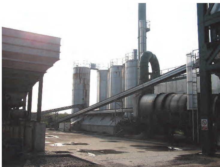
Figura 20 - Impianto di pretrattamento (essiccatore)
