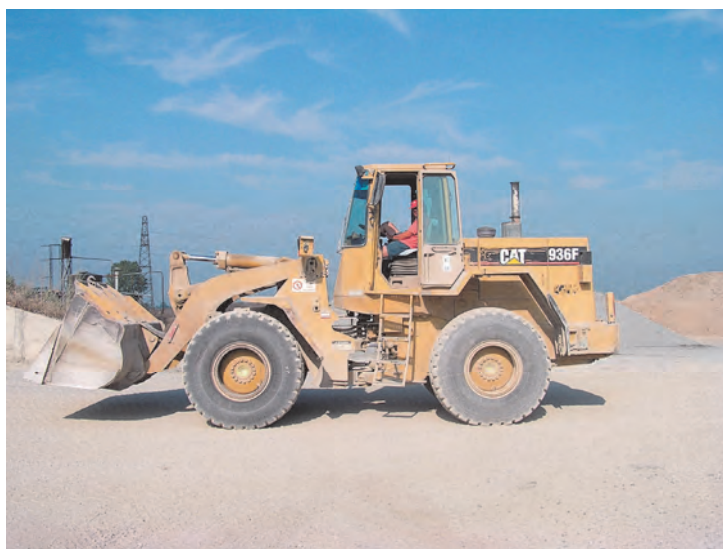
Figura 19 - Pala per movimentazione inerti
