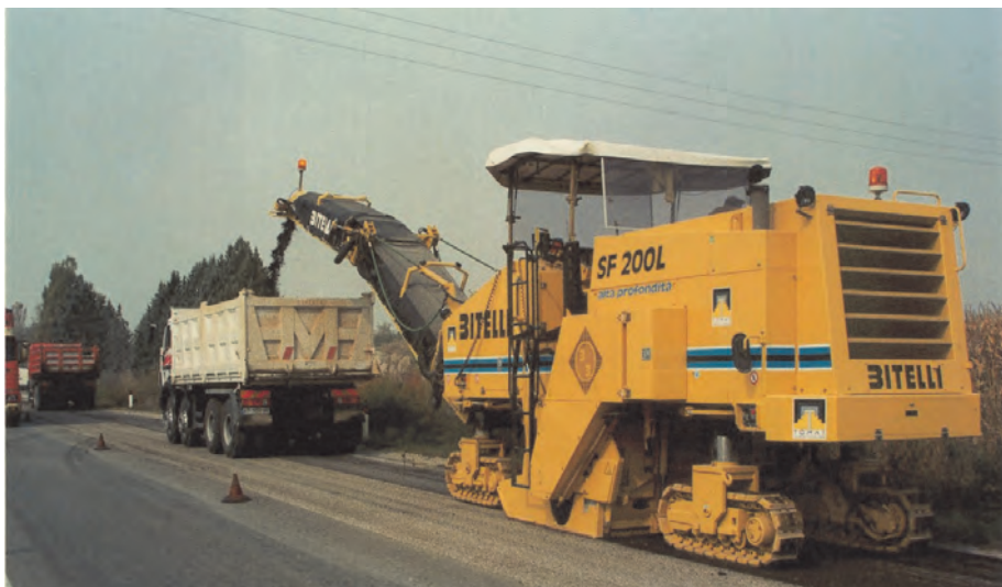
Figura 22 - Fresatrice o scarificatrice
