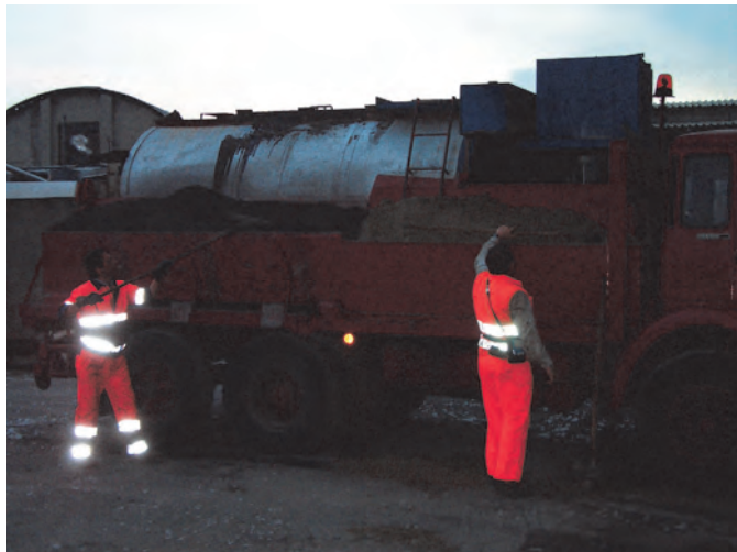
Figura 29 - Carico di "bonza" per trasporto asfalto colato
