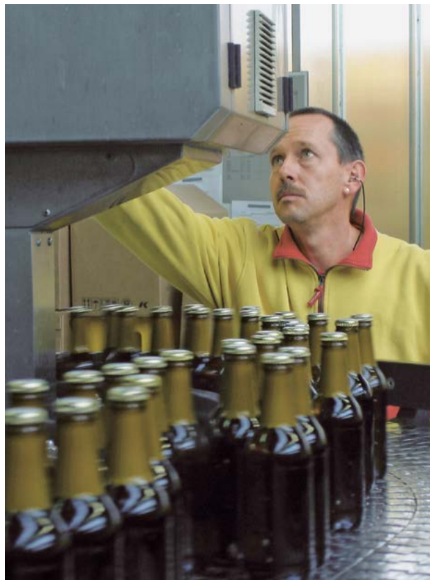
2 In molti processi industriali i lavoratori sono esposti a livelli di rumore molto alti (addetto ad un impianto di imbottigliamento).
