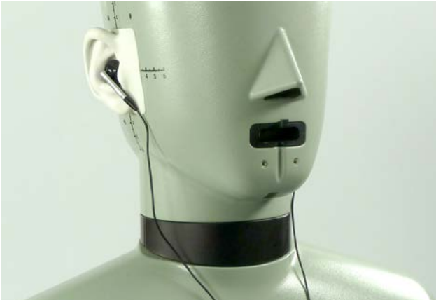
56 Misurazione del volume riprodotto dagli auricolari con una testa artificiale
