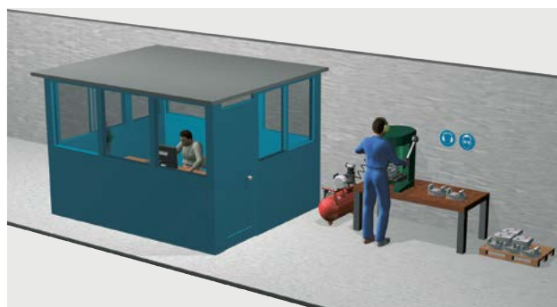
66 Tre tipi di misure antirumore: eliminare la sorgente di rumore, schermare la sorgente o proteggere la persona esposta.
