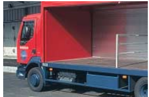
Camion à suspension pneumatique en position basse
