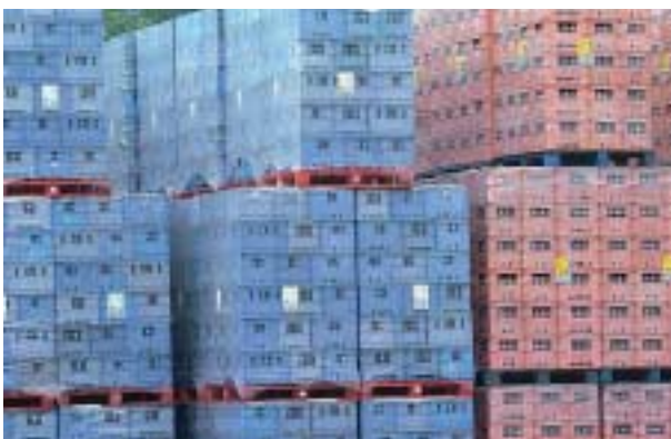
Palettes de casiers empilés sur trois hauteurs au total avec croisement sur la 3 e couche
