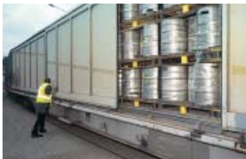
Opérateur poussant la porte d'un wagon et restant protégé
