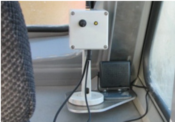
Fig. 13: Esempio di installazione di un rivelatore su un dumper (antenna sopra avvisatore sonoro qui accanto)
