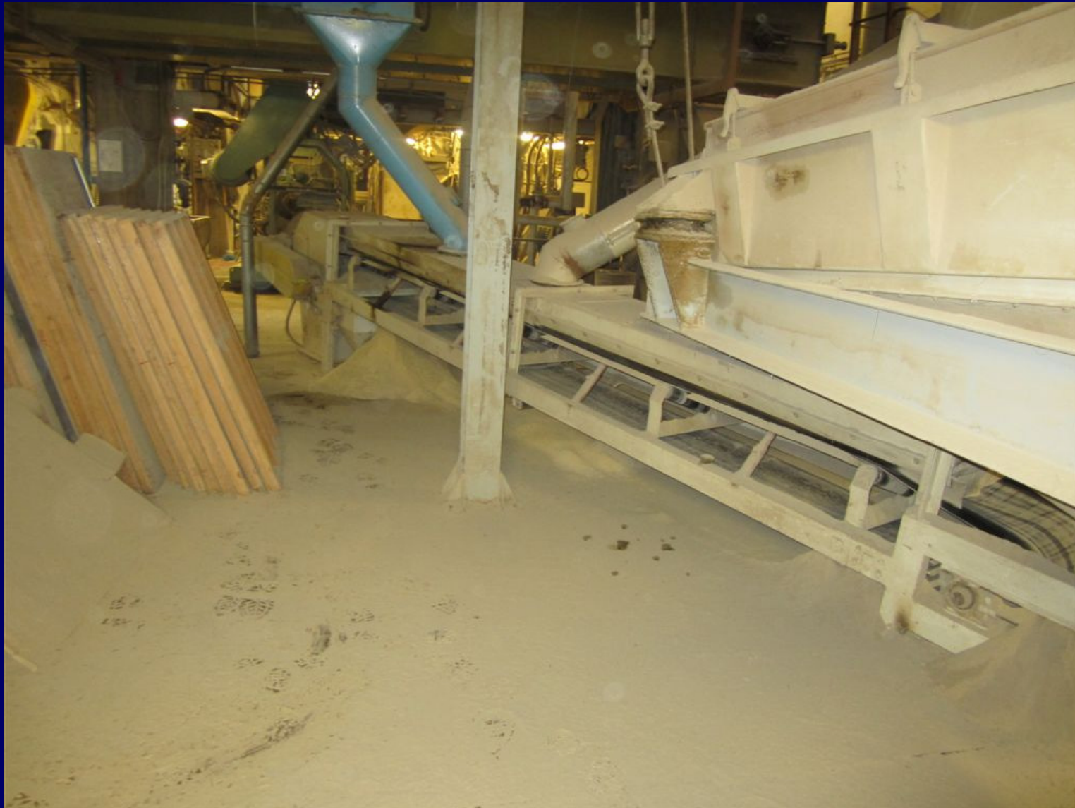
Vaglio vibrante: dispersion e accumuli di polvere
