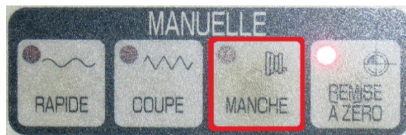
Figure 8 – Bouton de sélection de la télécommande (« manche »).
