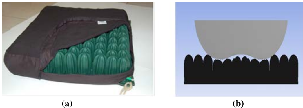
Figure 3.2 : (a) Représentation schématique du coussin à bulles d'air ; (b) crêtes et creux autour de chaque bulle.
