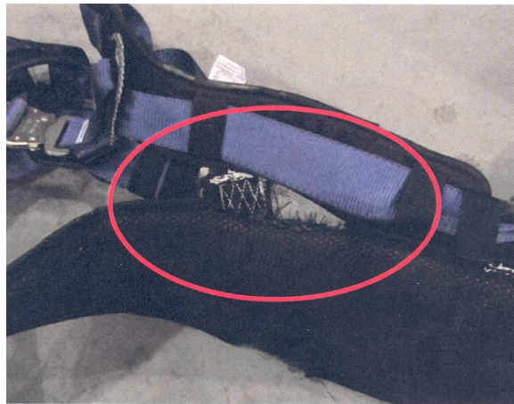
Figure 13 : Vue typique d'un arrachement des sangles au support dorsal du harnais
