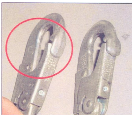
Figure 18 : Déformation de l'armature observée lors de l'essai de résistance A
