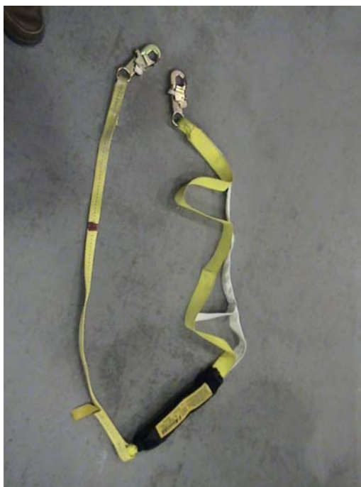
Figure 11 : Déformation de l'absorbeur d'énergie, après essai
