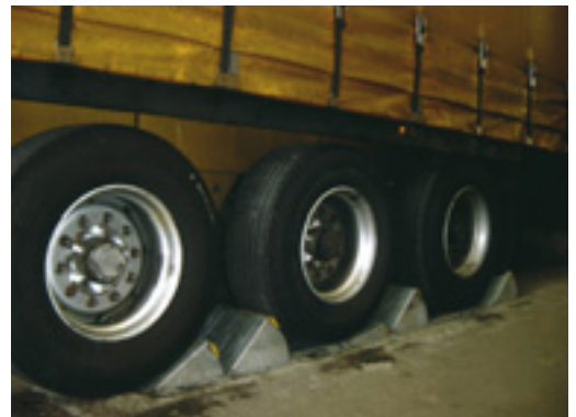
Photo 7.9. Dispositif de calage dynamique.
