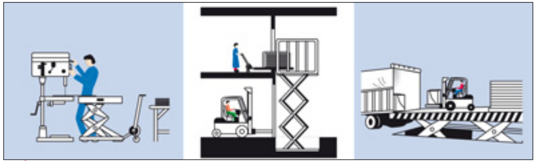
Figure 8.5. Exemples d'utilisation de tables élévatoires.
