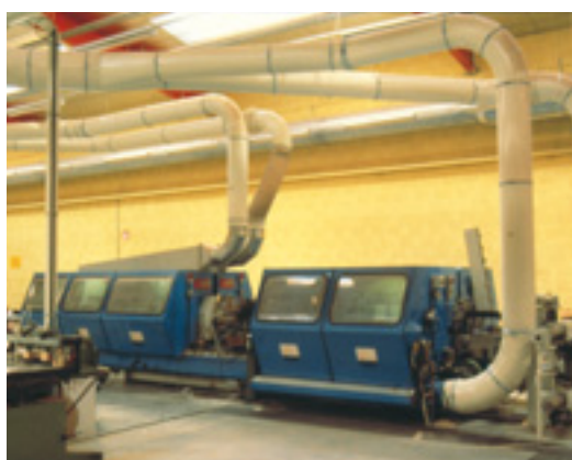
Photo 5.8. Assainissement par dispositifs de captage enveloppant.
